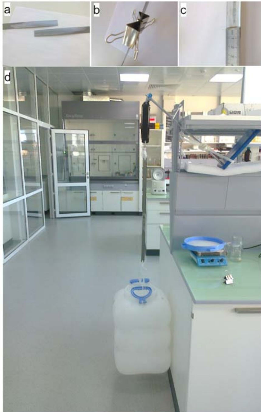
Рис. S1 Этапы склеивания пластин и установка для измерения адгезионной прочности полученного клеевого соединения. a – зачищенные металлические пластины; b – пластины в процессе склеивания; c – вид клеевого шва; d – вид установки для измерения прочности соединения; устройство черного цвета, к которому подвешен пакет адгерентов – пружинные весы
